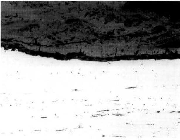
Fig. 5 : Objet A (fibule) : Coupe métallographique longitudinale. Aspect de la coupe d'oxyde et des inclusions subsurface (grossissement 25).
