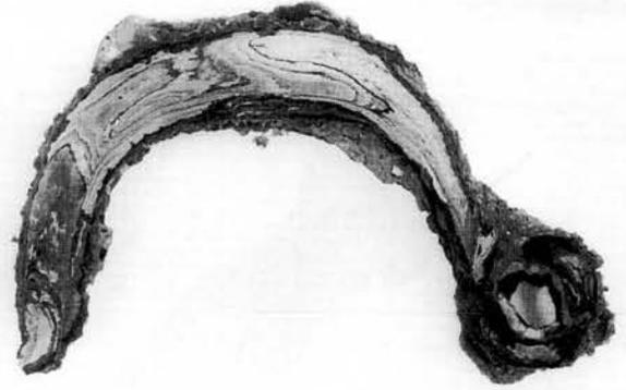
Fig. 6 : Objet A (fibule) : Coupe métallurgique longitudinale après attaque Nital.
