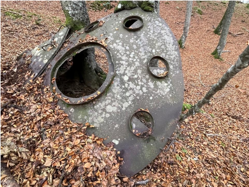
Lisse monobloc, avec passage central Ø 55 ici avec 8 événements réglables typique des "fours Forindust".
