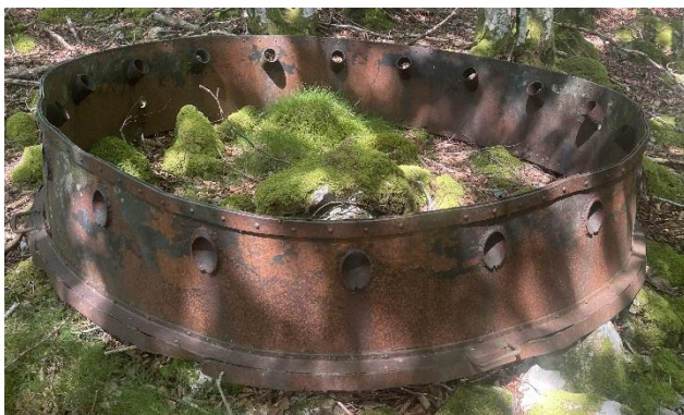
Ci-dessous, un élément de cuve intermédiaire (Ø int. 2,05m)
