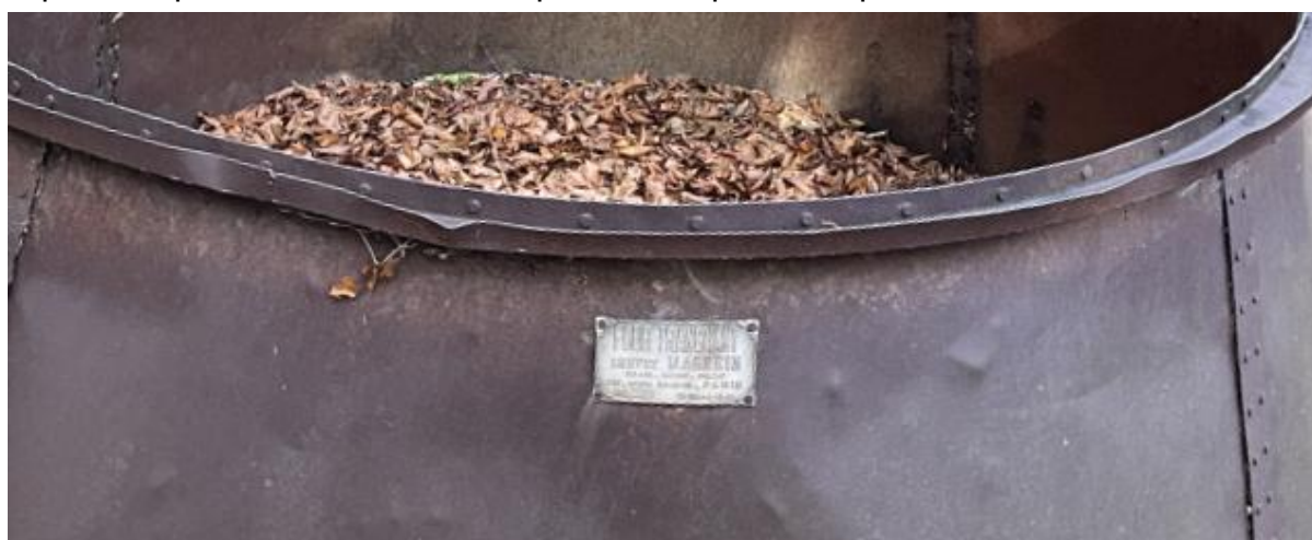
Ci-dessus, le fût riveté (double rangée), typique des "fours Tranchant ".
