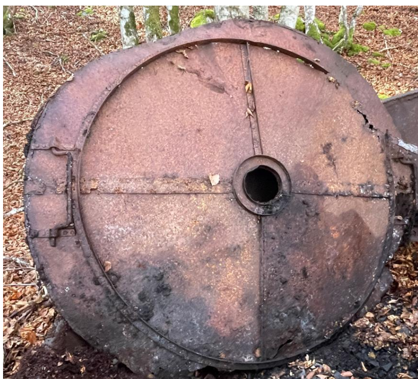
Lisse à 2 méplats et 2 cornières rapportés rivetés, avec passage central Ø 16, Typique des "fours Tranchant ".
