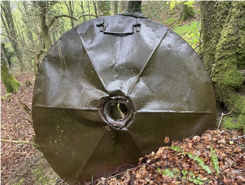
Lisse soudé avec 6 nervures par déformation, avec passage central Ø 16.
