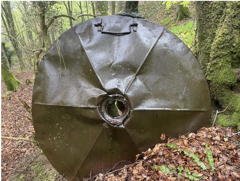
Lisse soudé avec 6 nervures par déformation, avec passage central \varnothing 16.
