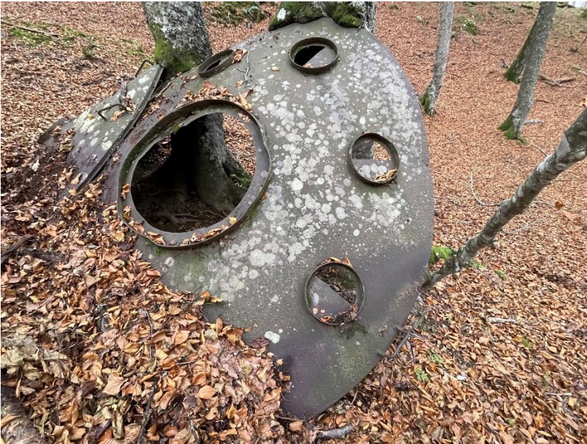
Lisse monobloc, avec passage central \varnothing 55 ici avec 8 événements réglables typique des "fours Forindust".
