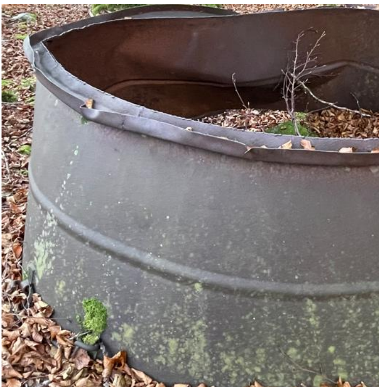
Ci-dessus, un fût soudé à une nervure circulaire horizontale, certains en ont deux !
