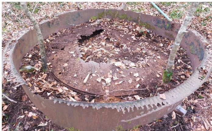
Cuve basse de type Lorraine reconnaissable à son appui gaufré et cuve haute à 12 nervures verticales, fabricant indéterminé.
